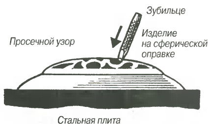
Рис. 13. Выполнение просечного узора на конфетнице с использованием сферической оправки.
