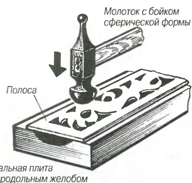
Рис. 14. Продольное выгибание металлической полосы с просечным узором.
