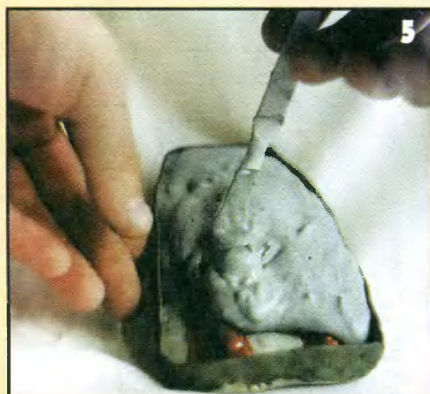
5 Залитую гипсом форму сушат в течение двух суток.
