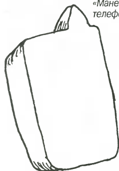
Рис. 1. Модель мобильного телефона вырезают из мягкой древесины (липы) или плотного пенопласта.
