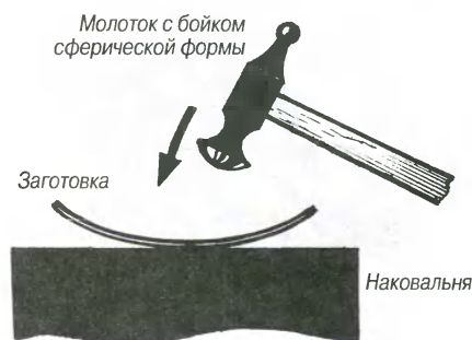
Рис. 12. Придание сферической формы заготовке с просечным узором.
