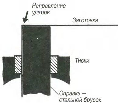
Рис. 10. Гибка заготовки на прямой угол.
