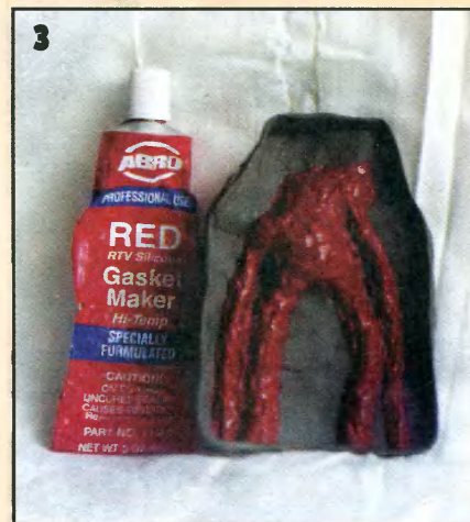
Застывший силиконовый герметик служит материалом для «рубашки» модели.
