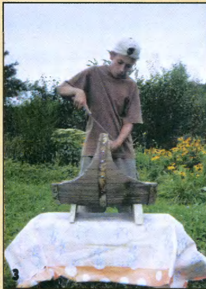
Перед покраской острые кромки ручьи дровницы и заусенцы на обруче надо обработать напильником.
